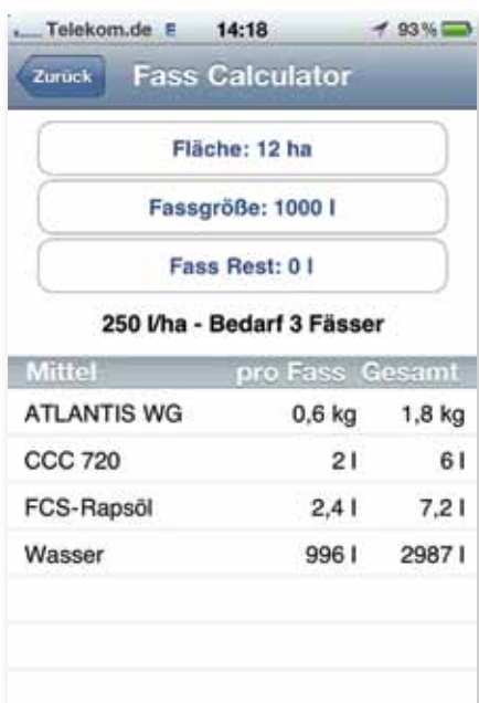
Der Spritzfassrechner berechnet für Sie, wie viele Tankfüllungen Sie benötigen und wie viel von welchem Mittel Sie einfüllen müssen.
