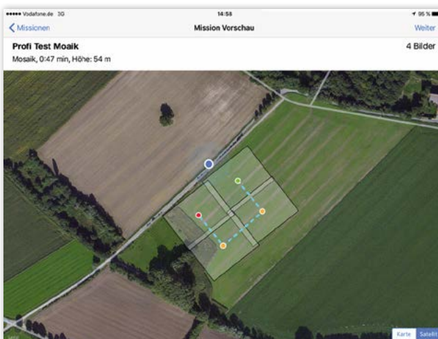
Die Cockpit-Ansicht von Farmbird kurz vor dem Start der Drohne: Der blaue Punkt ist der Start- und Landeplatz. Ausgewählt hat der Pilot eine in Feldpixel geplante Mission.
