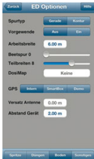
In den EasyDrive-Optionen lassen sich alle Parameter fürs Parallelfahren einstellen.
