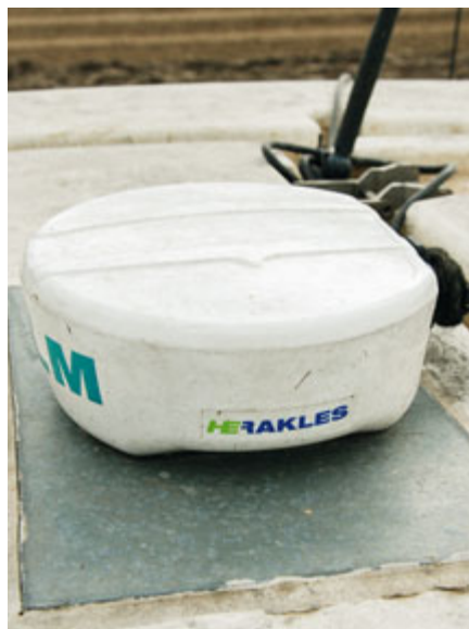
Der GPS-Empfänger gibt sein Signal an einen WLAN-Router in der Kabine weiter.
